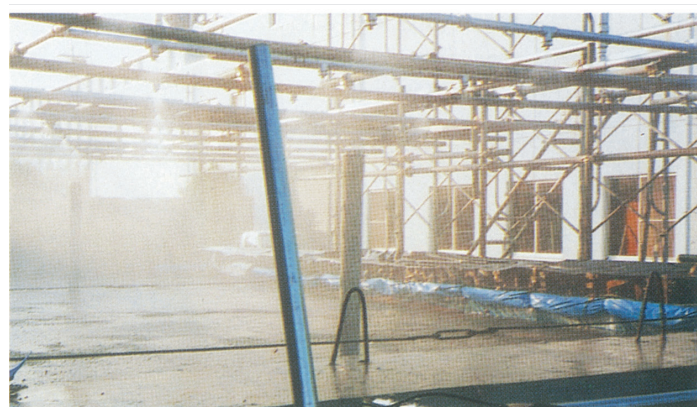
擁壁天端面のスプリンクラーからの降雨状況（150mm/h）
