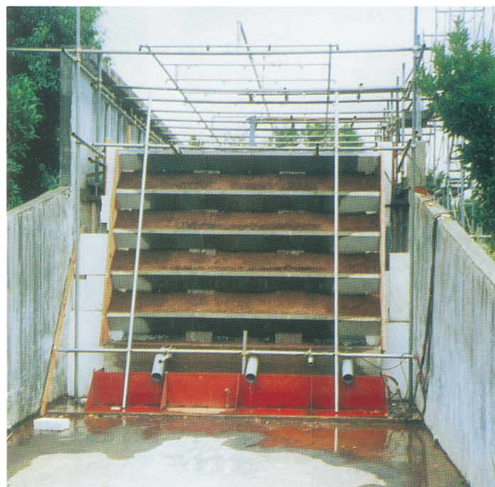
降雨量 150mm/h 完了後の擁壁表面
