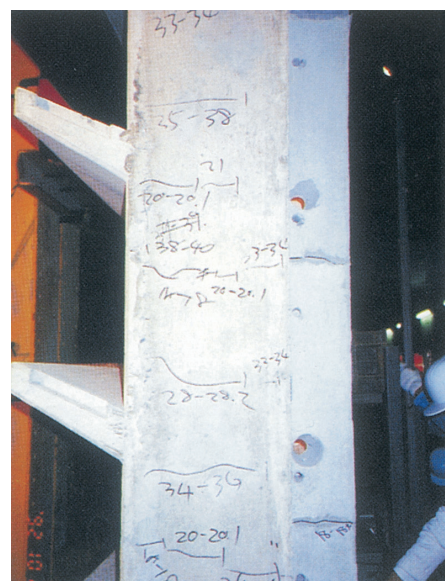
胴込コンクリート破壊時の擁壁端部と天端のひび割れ状態風景。 実験結果、1ブロックのみ集中荷重を与えた場合でもブロック間の胴込コンクリートを介して、応力は伝達されていることが理解できます。
