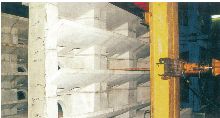
緑生ブロックⅡ型を3段、3列に組積して、中央ブロックのみに集中荷重をかけている実験風景。
